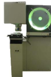
Проектор измерительный ПИ-600ЦВ1 с диаметром экрана 600 мм., с цифровым отсчетом на индикаторном табло, с расположением оптической оси объектива в вертикальной плоскости, предназначен для измерения и контроля линейных, угловых размеров в проходящем и отраженном свете. Проектор изготавливается по техническим условиям ТУЗ-3.2259-91.
