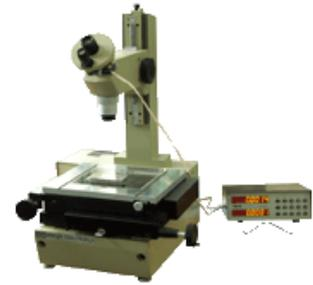
Измерение можно проводить в прямоугольных и полярных координатах:
