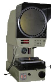
Проектор изготавливается по техническим условиям АЛЗ.826.105ТУ и предназначен для измерения, контроля линейных и угловых размеров в проходящем и отраженном свете в прямоугольной и полярной системе координат с использованием преобразователей ПЛФ и цифровой обработкой результатов измерения устройством УЦО-209С, в частности: резьбовых изделий, режущего инструмента, профильных шаблонов, лекал, кулачков, валов, конусов, печатных плат и т.д.
